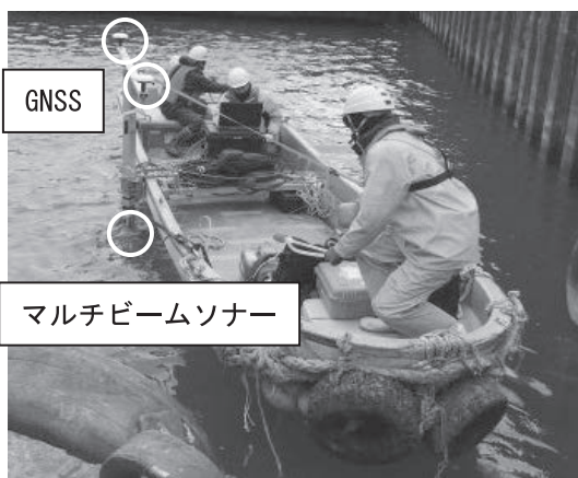
写真—3 作業船による深淺測量状況
