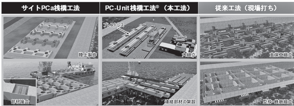
図-1 栈橋工法の一覧
