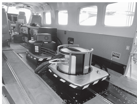
写真-2 固定翼に搭載されたALBセンサ (奥：Shallowタイプ 手前：Deepタイプ)
