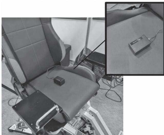
写真一4 椅子の上に IMU センサを固定
