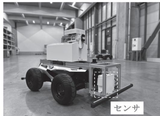
図一九 センサ搭載型自律走行式ロボット
