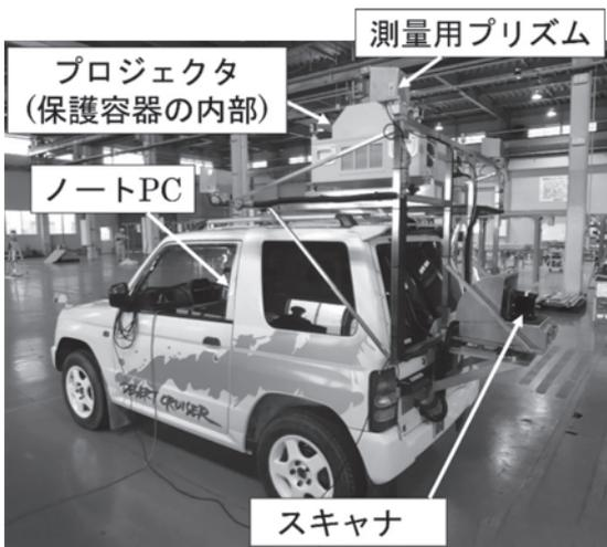
図—2 切羽版システムの構成機器
