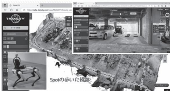
図一12 カメラ搭載 Spot による動画撮影と点群
