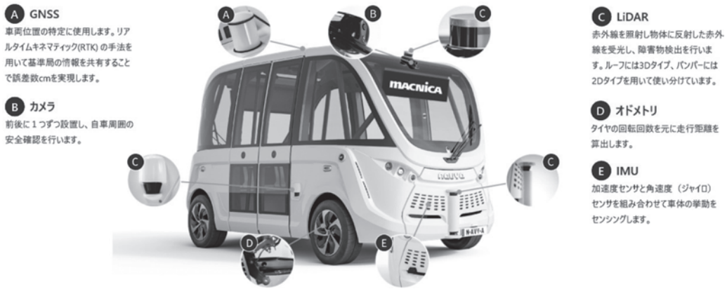
図一 自動運転シャトルバスのセンサー構成
