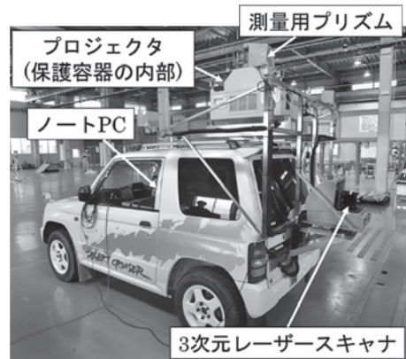
図-3 切羽版 SP-MAPS の機器構成
