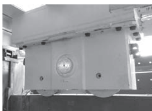
①内型枠区間車輪
