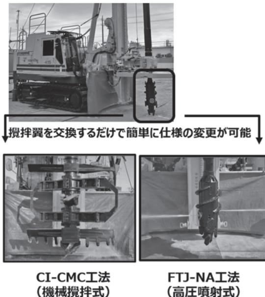
図-4 CI-CMC工法とFTJ-NA工法
