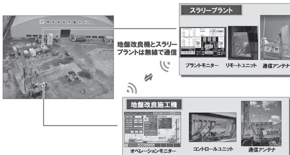
図一 自動打設システム概要
