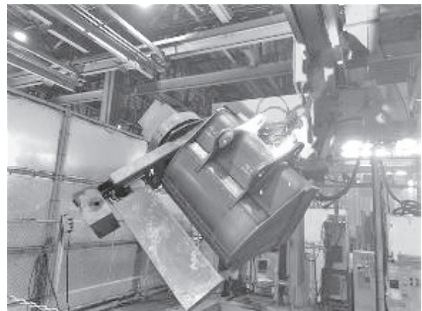
写真三 バケットのロボット溶接
