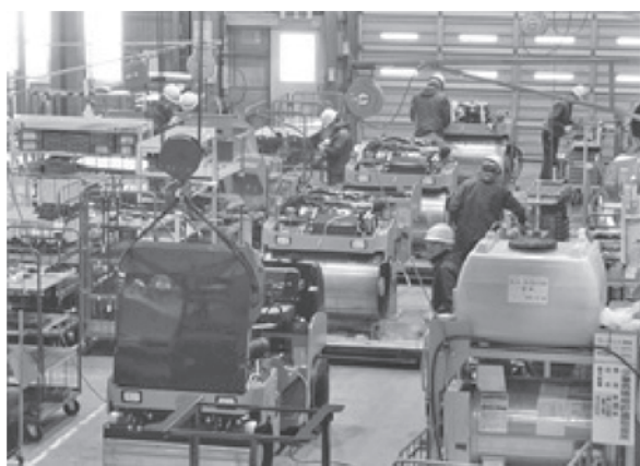
写真-5 締固め機械の生産ライン
