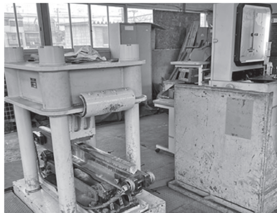
写真—6 レール破断試験
