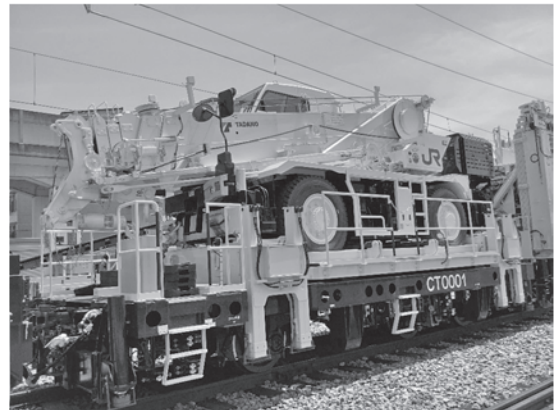
写真—4 電柱建植車
