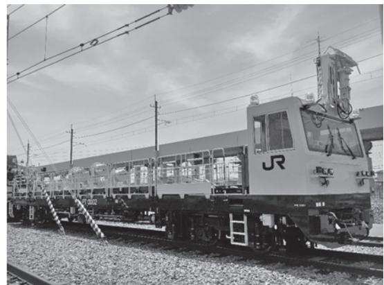
写真—5 電柱運搬車
