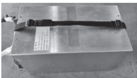
写真-4 リチウムイオンバッテリー外観
