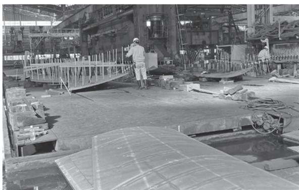
写真—5 成形されたブロック外板（手前）
