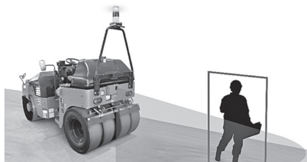
写真一5 「衝突被害軽減アシスト装置」作動時イメージ
