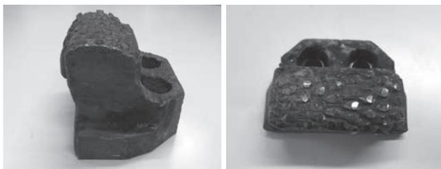
写真—6 摩耗した切削ビット
