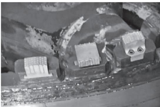
写真-3 切削ビット配置状況
