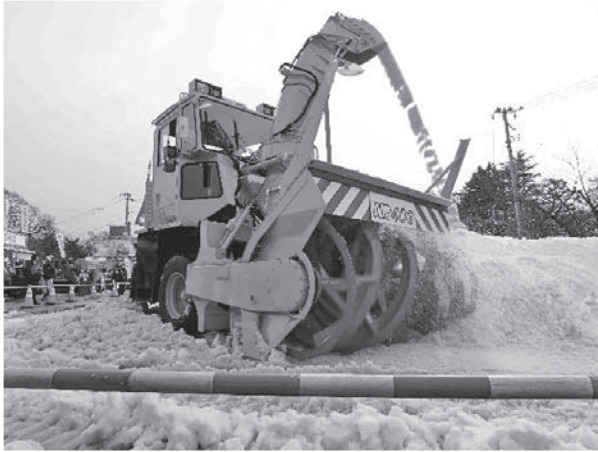
写真一 24, 25 新潟トランス(株) ロータリ除雪車 NR403
