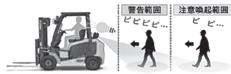
図-15 衝突検知警報システム
