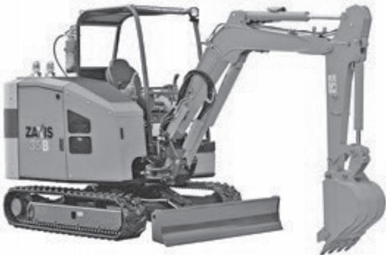
写真一八 3.5tクラスバッテリー駆動式ミニショベル (2010年)
