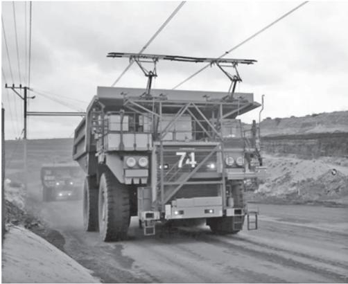
写真一3 トロリー受電式ダンプトラック (2018年)
