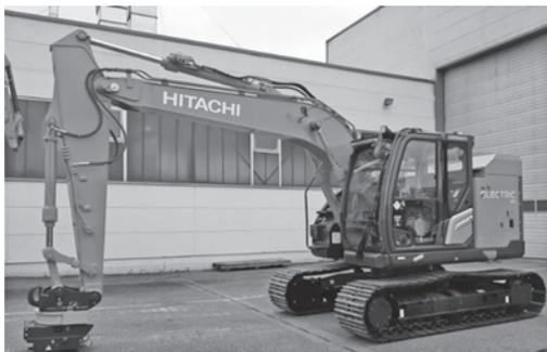
写真—13 13tクラスバッテリー駆動式ショベル試作機
