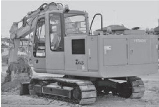
写真一七 バッテリー駆動式油圧ショベル (2007年)
