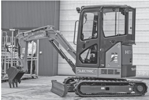
写真—12 2tクラスバッテリー駆動式ショベル試作機
