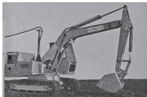
写真—2 電動式油圧ショベル（1971年）
