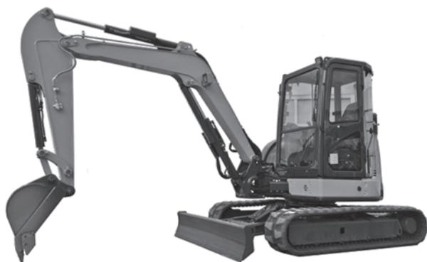
写真—9 5tバッテリー駆動式ミニショベル試作機
