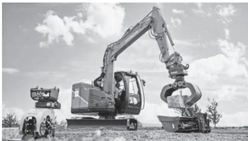
写真—14 8tクラスバッテリー駆動式ショベル
