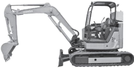
写真一六 5tクラスバッテリー駆動式ミニショベル (2006年)
