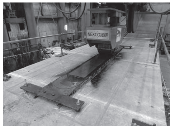
写真一1 輪荷重走行試験
