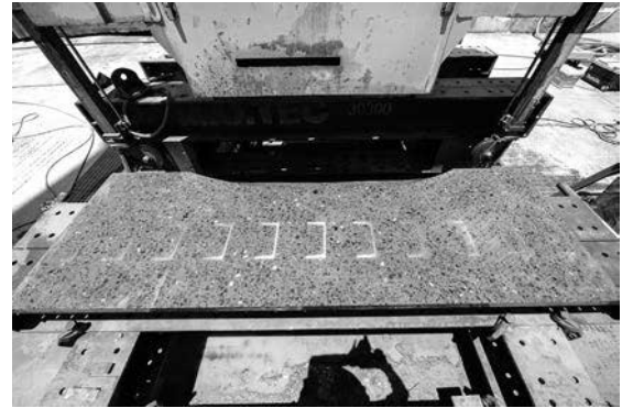
写真一4 切り下げ切断箇所 断面状況
