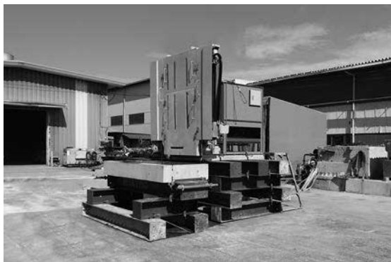
写真-1 基礎躯体クールカット装置
