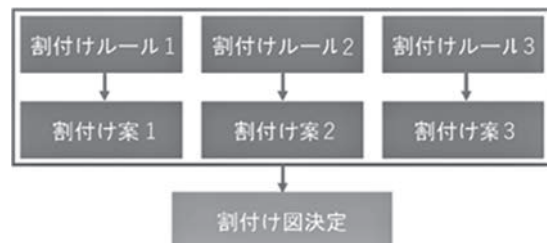
図-9 割付け図決定フロー
