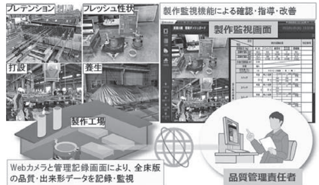
図一4 床版製作工場の監視システム
