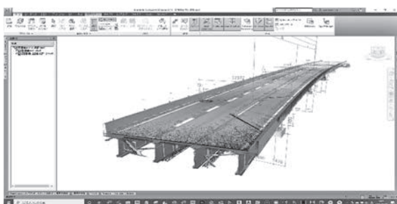
図一 17 既設橋梁計測点群データ
