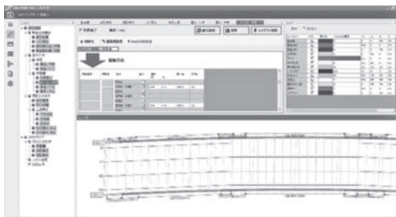
図一 11 壁高欄割付け入力画面
