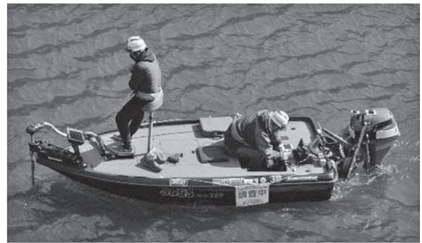
写真-1 ソナーマッピング計測調査船の例
