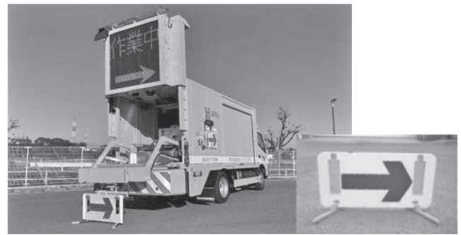
図-5 矢印板自動設置・回収車両と専用矢印板
