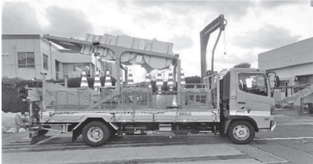
図-3 自社開発ラバーコーン自動設置・回収車両試作車
