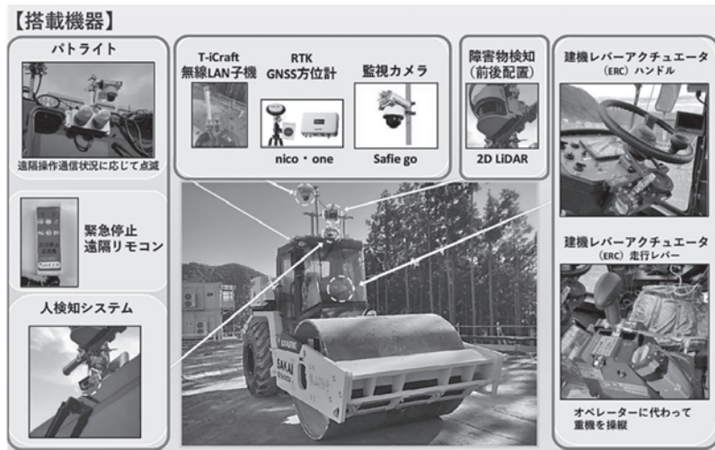
図一5 自動化振動ローラ:(酒井重工業 SV900 18t級 ERC仕様)
