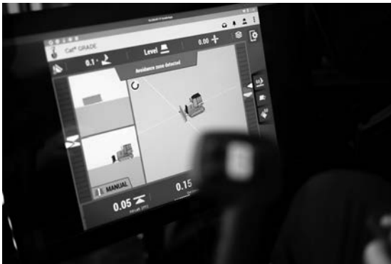
写真一八 3D マシンコントロール画面
