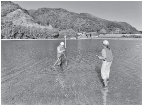
写真-2 VRS-GNSS 計測状況
