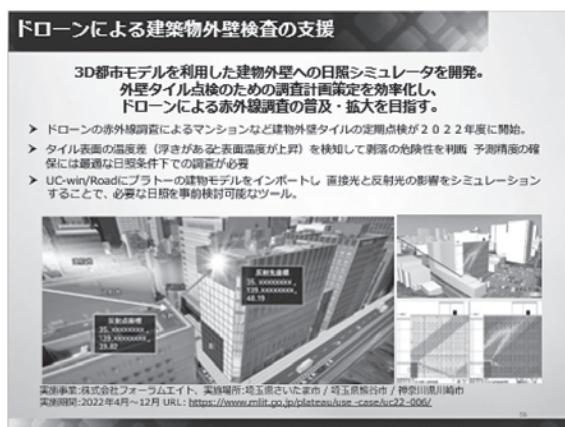
図-3 PLATEAU (プラトール) を活用したドローンによる建築物外壁検査の支援
