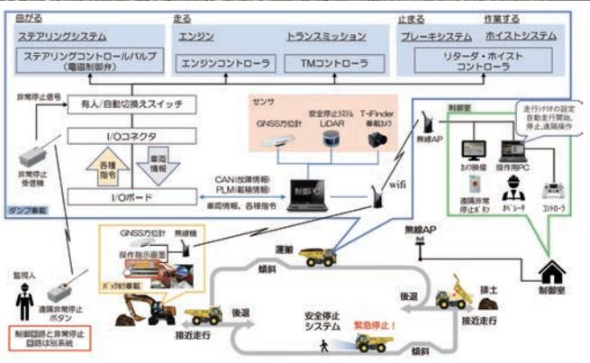
55t級リジッドダンプによる自動運転システム開発
