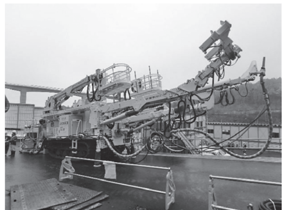
写真—5 エレクター搭載一体型吹付け機（天神トンネル作業所現場概要資料より）
