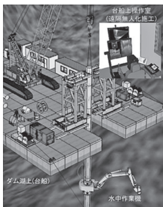
図一 T-iROBO UW による作業状況
