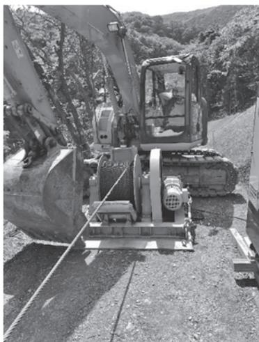
写真-1 ウィンチと0.45 m<sup>3</sup>油圧ショベル（重量物置換アンカー）
