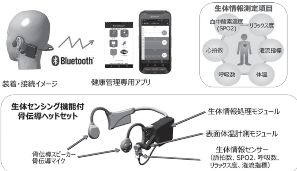
図—1 生体センシング機能付骨伝導ヘッドセット概要
