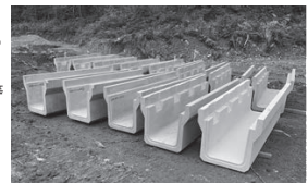
グリーンイノベーション基金を活用した低炭素型コンクリート試行事例(秋田県東成建設)
