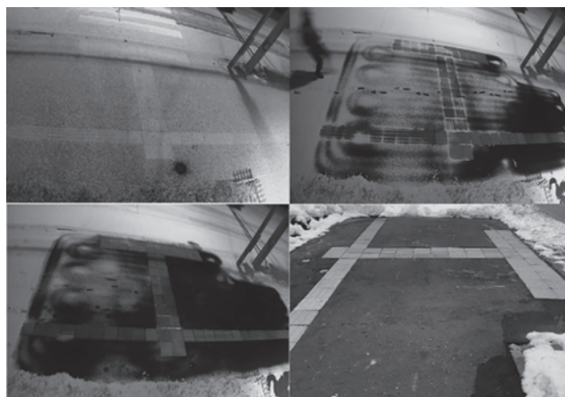
写真—2 ヒートポンプ式システム 融雪状況
