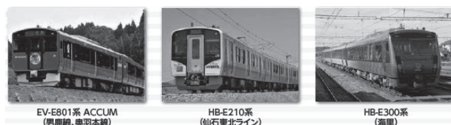
写真-4 蓄電池車・ハイブリッド車
