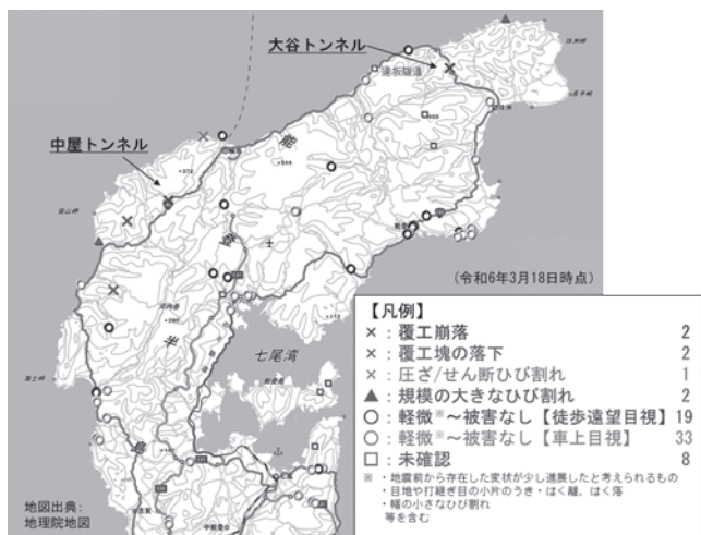
図—10 トンネルの被害状況（専門調査結果）
