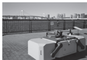
c) DJI Dockの設置状況
