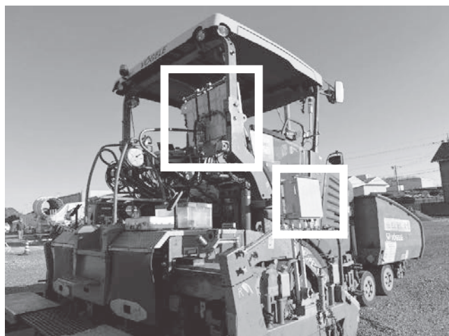
写真—4 AFに搭載した通信・制御PCユニット（白枠部）
