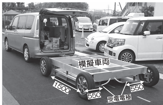
写真一 8 模擬車両（トレーラ）概要
