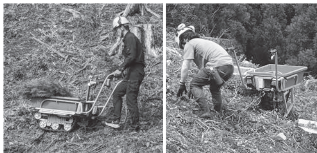
写真—4 造林作業向け電動一輪車による苗木運搬の様子(左)、斜面で自立させている様子(右)
