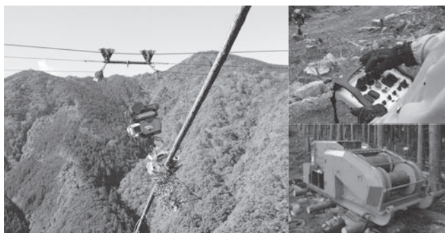
写真—1 架線式グラップル(左)、遠隔操作の様子(右上)、油圧集材機(右下)
