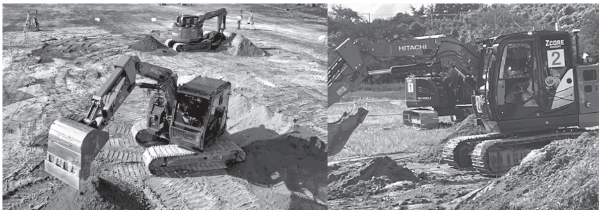
写真一 油圧ショベルによる自律運転の実証試験
