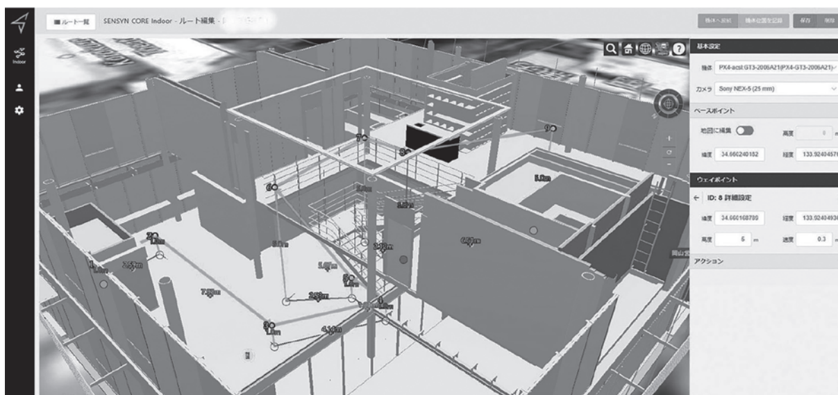
図-3 BIMを活用した運用システム操作画面
