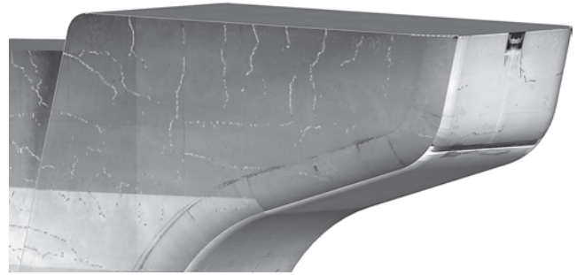
図一5 本技術により得られたひび割れ図を3次元表示した例 4)
