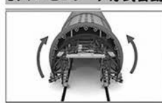
図—6 覆エコンクリートシステムの自動化
