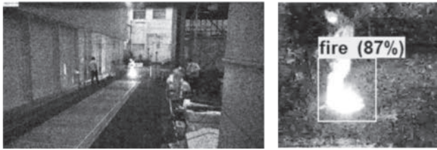
(a) 検出結果画像全景 (b) 火源位置拡大 写真—4 火災検出処理試験における検出画像
