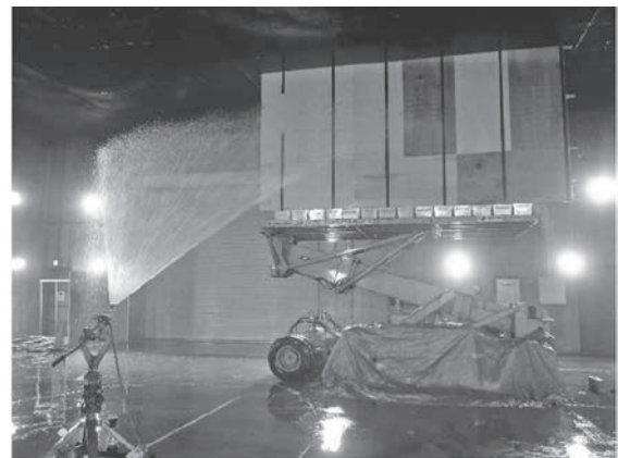
写真—6 高所壁面への放水性能の検証実験
