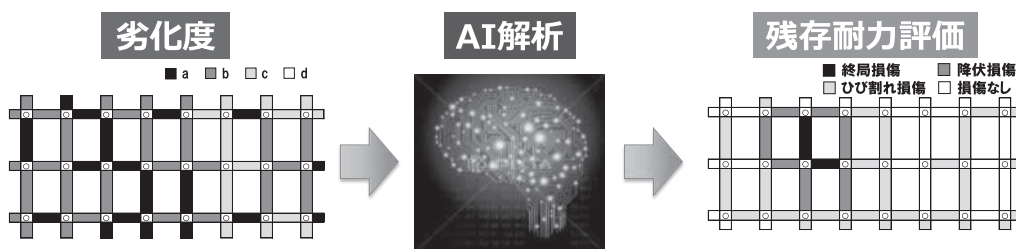
図—4 AIを用いた栈橋の残存耐力評価
