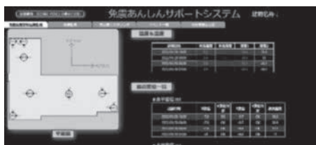
免震装置変形遠隔監視
